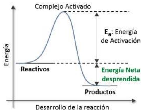
**La entalpía** es una magnitud que define el flujo de energía térmica en los procesos químicos que ocurren a presión constante. Además, esta magnitud representa el intercambio de energía entre un sistema termodinámico y su entorno. La variación de esta magnitud ( $\Delta H$ ) en una reacción química se utiliza para clasificar a la reacción en endotérmica o exotérmica.
