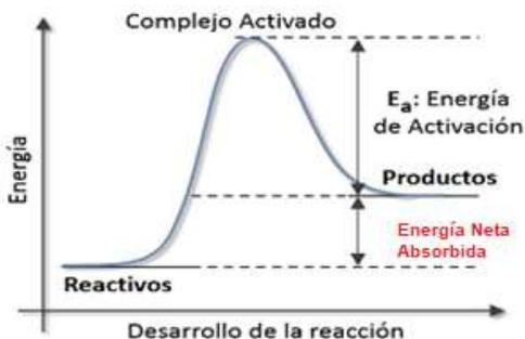
La *reacción endotérmica* requiere de una determinada energía de activación ( $E_a$ ) para alcanzar el *complejo activado* y espontáneamente transformarse en productos. La energía de los reactivos es mínima y la de activación grande, por lo que necesita energía o calor para reaccionar.
